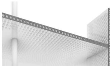
Die Mesogradierung von Betonbauteilen ermöglicht es, die innere Struktur eines Bauteils entsprechend statischer und bauphysikalischer Anforderungen zu optimieren. Durch einen Einsatz von mineralischen Hohlkörpern wird die Bauteilmasse signifikant reduziert und eingesetztes Material homogener ausgenutzt. Darüber hinaus bieten mesogradierte Betonbauteile Vorteile im Rezyklierverhalten aufgrund des mineralisch sortenreinen Baustoffs.
