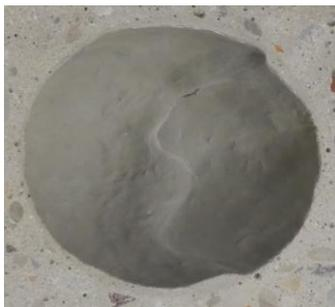
Offene Fragestellungen betreffen die bestehende Hohlkörperproduktion, da trotz biaxialer Rotation die Wandstärke der Hohlkörper im einstelligen Millimeterbereich nicht immer homogen erreicht wird. In Zusammenarbeit mit der Materialprüfungsanstalt (MPA) soll ein ultraschallbasiertes Messverfahren aufgesetzt werden. Erste Vorversuche hierzu wurden erfolgreich durchgeführt.
