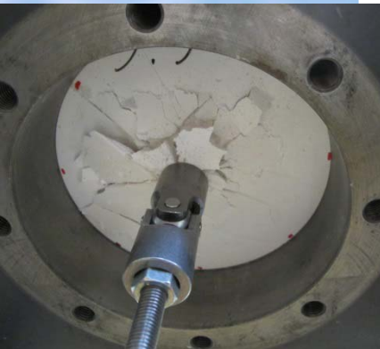
Prüfung der Tragfähigkeit von Befestigungspunkten sowie des Biegetragverhaltens des Faserverbundwerkstoffes
