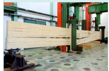
Prüfung eines Hess-Limitless-Stoßes
