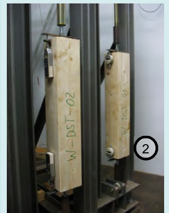
Dauerprüfstand für eingeklebte Stahlstangen
