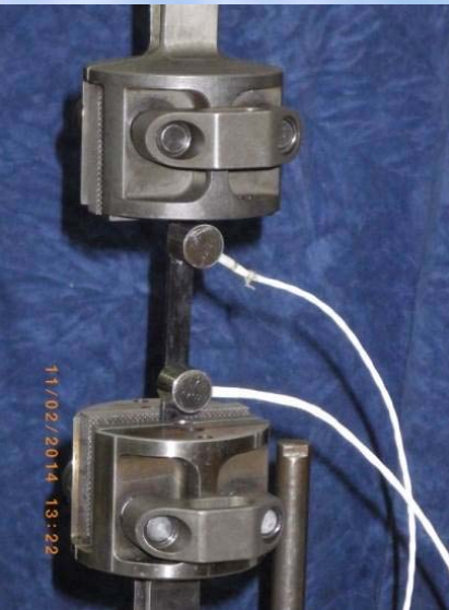
Versuchsaufbau: eingebaute Probe mit Schallemissionssensoren
