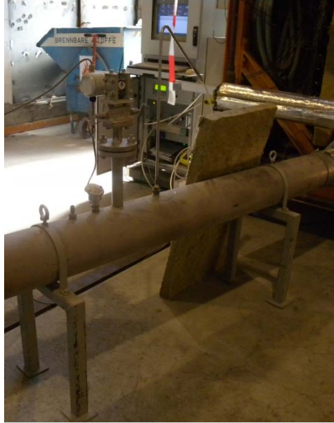
Messstrecke (CO 2 und Volumenstrom)
