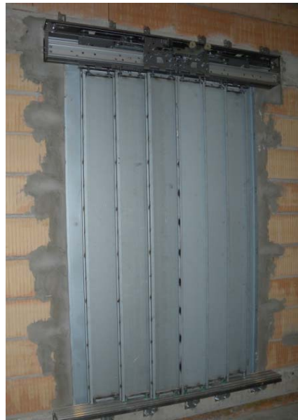
In Prüfwand eingebaute Fahrschachttür
