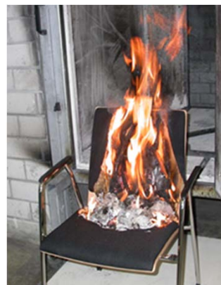
Prüfung eines Polsterstuhls nach DIN 54341
