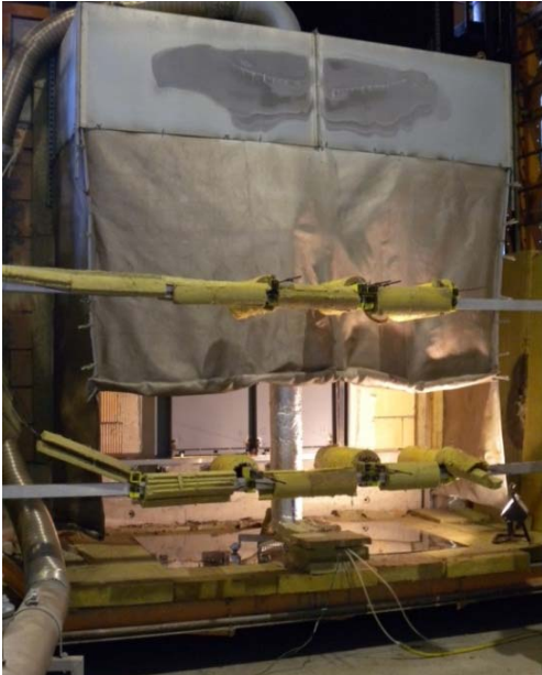
Fahrtschachttür mit montiertem Baldachin
