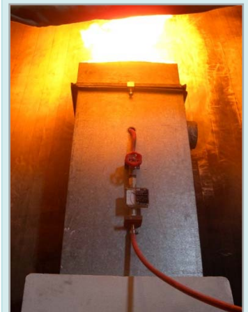
Kalibrierbrenner zur Bestimmung der Genauigkeit des Messsystems vor der Brandprüfung
