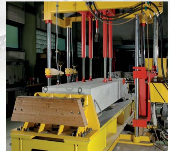
3D-Anlage: Prüfung von Befestigungselementen im gerissenen Beton
