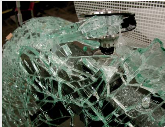
Belastungsversuch an einer großen Verbundglas-scheibe und Versagensbild an einem Glaspunkthalter
