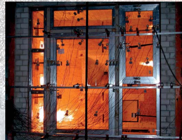
Prüfung einer Feuerschutztür nach DIN 4102-5 in einer Verglasung, kurz nach Beginn der Beflammung
