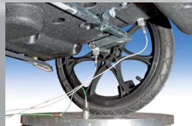
Schwingungsuntersuchungen an Fahrradanhängern zur Bestimmung der Eigenfrequenz nach DIN EN 60068 - 2 - 6 in vertikaler Richtung
