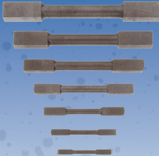
Festigkeitsuntersuchung an additiv gefertigten Materialien
