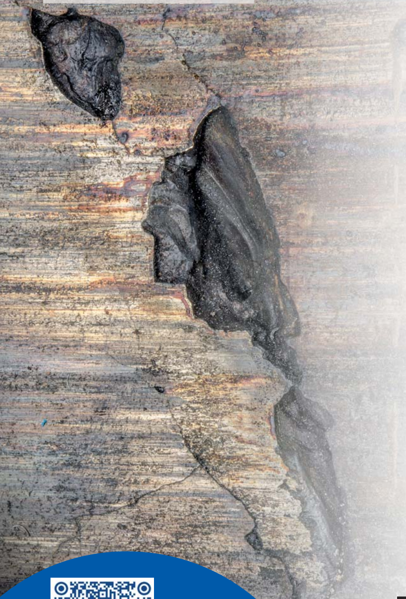
Pfropfen-Entzinkung an einem Messing-Bauteil
