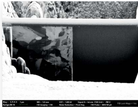
FIB-Präparation einer nicht artgleichen Schweißverbindung aus hochwarmfestem Stahl und Nickellegierung
