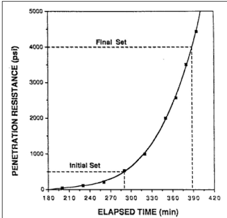
Fig. 1. Penetrometer test [Bunke, 1991].
