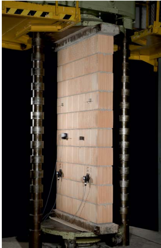
Ermittlung des Druck- und Verformungsverhaltens von Mauerwerk
