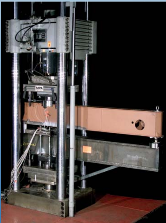
Dauerschwingversuch an Kranbauteilen
