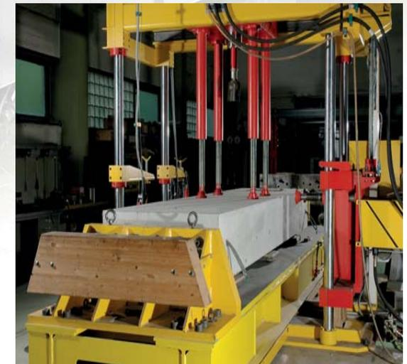
3D-Anlage: Prüfung von Befestigungselementen im gerissenen Beton
