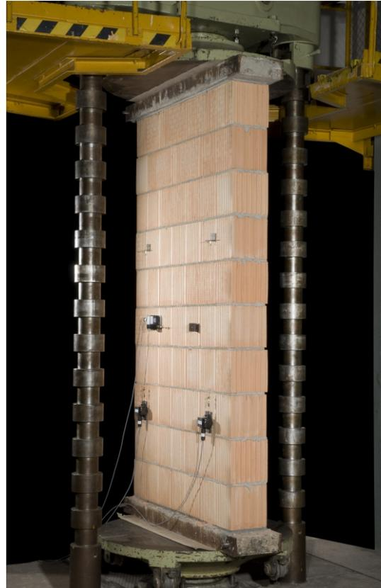
Ermittlung des Druck- und Verformungsverhaltens von Mauerwerk
