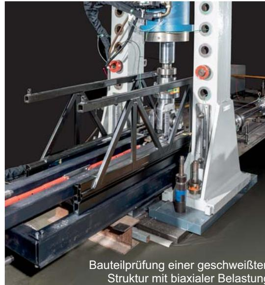
Bauteilprüfung einer geschweißten Struktur mit biaxialer Belastung
