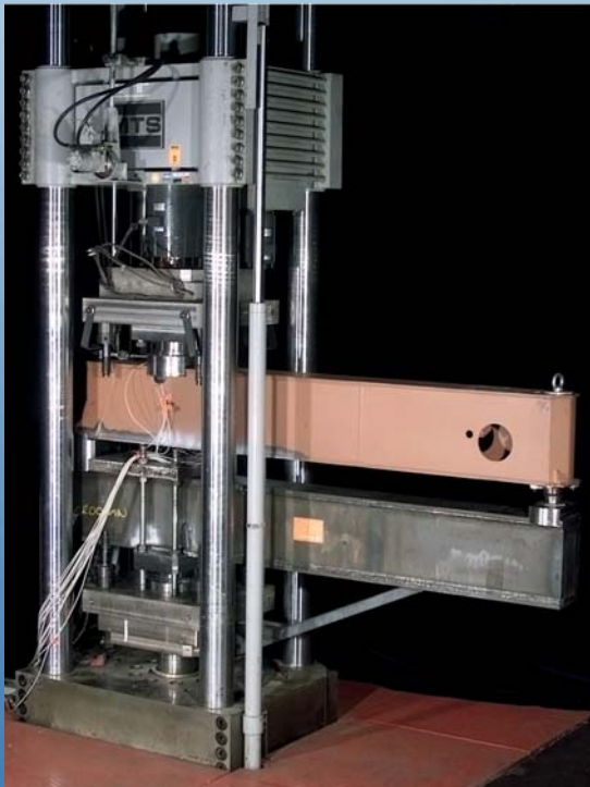
Dauerschwingversuch an Kranbauteilen
