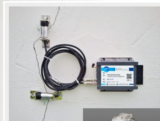
Kontinuierliches Rissbreitenmonitoring mit drahtlosem Sensorknoten
