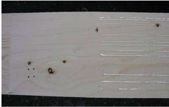
Bild 1 Brettschichtholzlamelle vorbereitet für Herstellung einer Modellfehlstelle: Übergang zwischen einem Abschnitt ohne Klebstoffauftrag und dem daran anschließenden ordnungsgemäß beleimten Abschnitt
