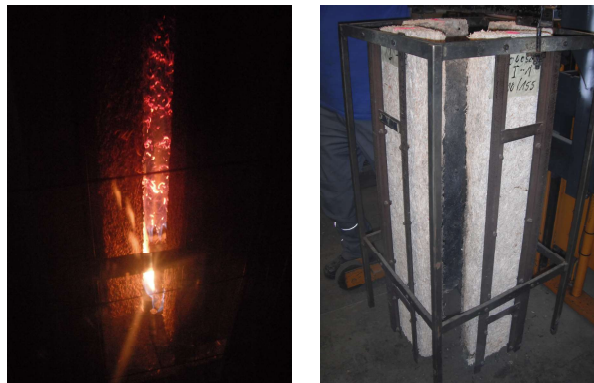
Bild 3 Prüfung im Brandschacht nach DIN 4102-1 [1]. Holzwolle-Platten mit reduziertem Bindemittel und nachträglichem Aufsprühen des Brandschutzmittels. Das linke Bild zeigt die Holzwolle-Platte während des Versuchs im Brandschacht. Das rechte Bild zeigt den Probekörper unmittelbar nach dem Versuch im Brandschacht.
