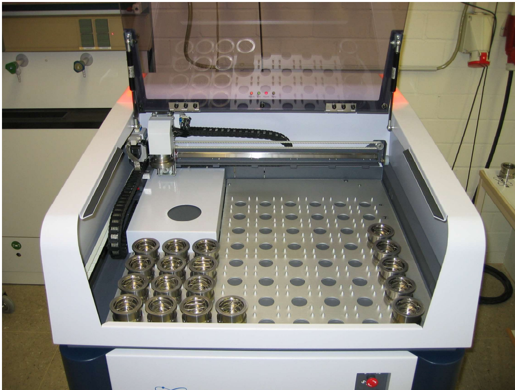
Bild 2: Blick in das Probenmagazin der neuen, kompakten Bruker S4 Pioneer Röntgenfluoreszenz mit Rh – Röhre.
