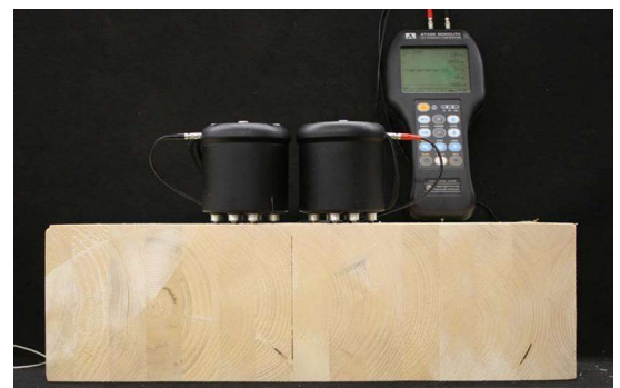
Bild 4 Photo der Ultraschall-Clustersensoren in Echo-Anordnung und der Pulser-/ Receiverinheit
