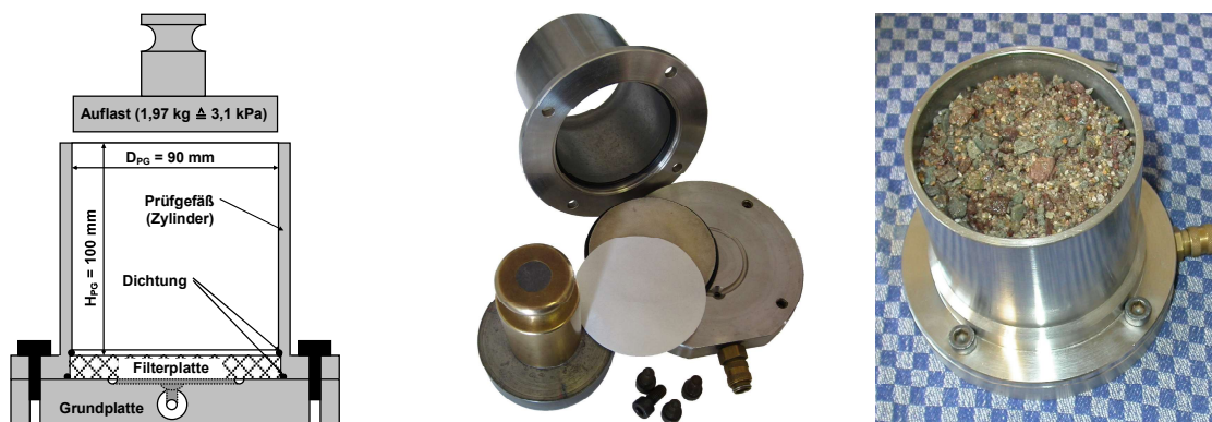
Bild 2: Prüfgefäß für die KGP (links: unmaßstäbliche Skizze des Längsschnitts mit Auflast für die Verdichtung; Mitte: Einzelteile; rechts: Gefäß mit Korngemisch)
