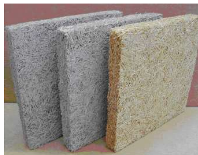
Bild 1 Ansicht verschiedener Holzwohle-Platten. Herkömmliche Platten (graue Platten) und die optimierte Platte (gelb)
