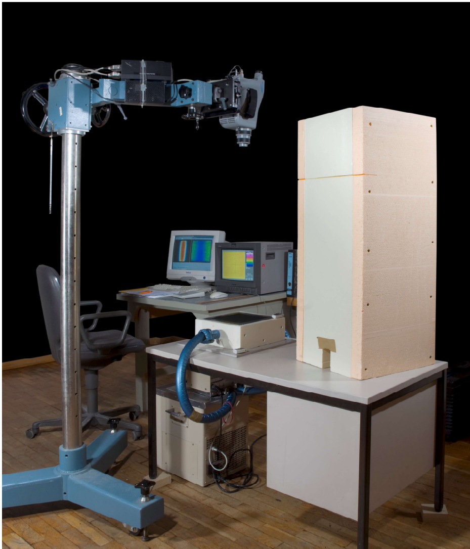
Bild 7: Prüfaufbau zur Ermittlung des thermischen Verhaltens von Heizstrichen
