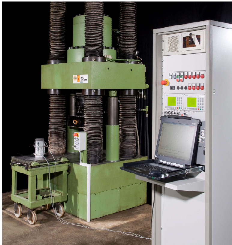
Bild 4: Modernisierte Steuerung der Vier-Säulen-Prüfmaschine
