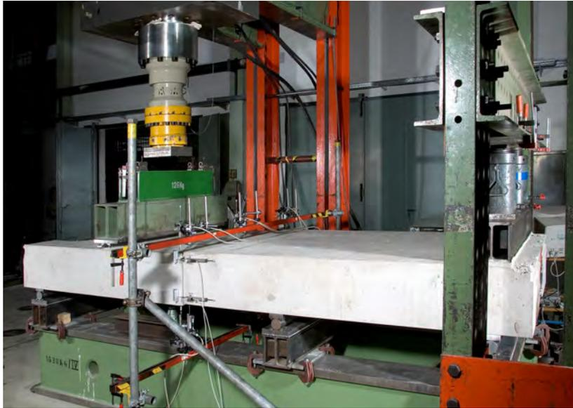
Abb.: Querlastversuch an großformatiger Schubdornverbindung
