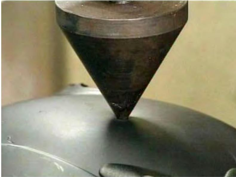
Bild 3: Bestimmung der Durchdringungsfestigkeit
