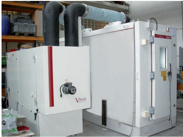
Bild 7: Ansicht des Bewitterungsprüfstands (links: Klimagerät, rechts: Prüfkammer)
