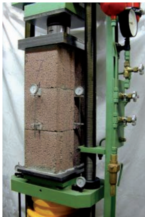
Bild 5: Ermittlung des Kriechverhaltens von Mauerwerk
