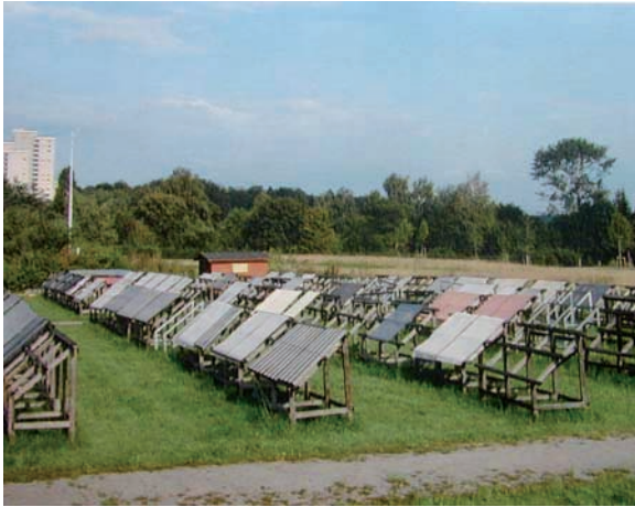
Freibewitterungsstände nach DIN 4102
