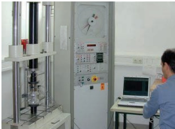
Bild 2: Prüfeinrichtung zur Bestimmung des statischen Druck-Elastizitätsmoduls von Beton
