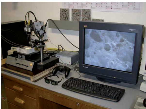
Bild 3: Messtand zur Luftporenzählung von Beton
