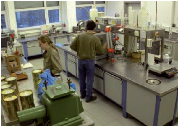
Bild 1: Klimatisiertes Prüflabor für mechanisch- physikalische Bindemittel- und Mörtelprüfungen
