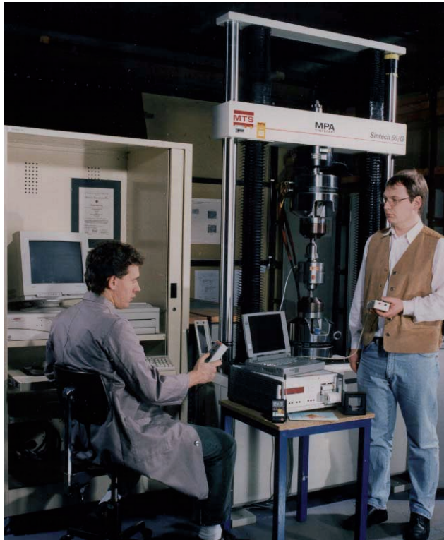
Kalibrierung einer Werkstoffprüfmaschine
