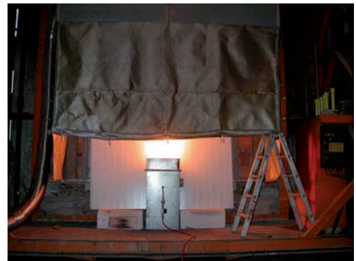
Brandversuch nach EN 81-58 an einer Fahrschachttür
