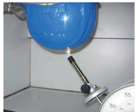
Prüfung der Flammbeständigkeit von Schutzhelmen
