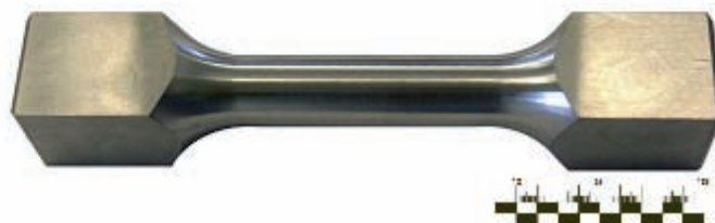
Bild 5: Zylindrischer Hohlprobe für Schwingversuch bei 288 oC
