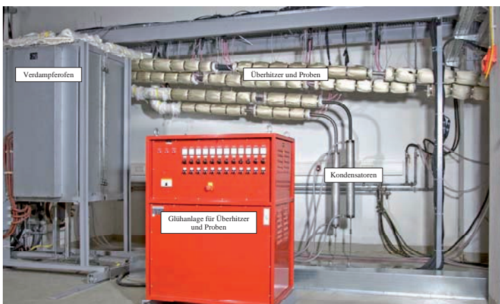
Prüfstand zur Prüfung von Kesselrohren und Druck- und Dampfbedingungen und Prüflinge vor dem Verschweißen und Einbau in den Prüfstand
