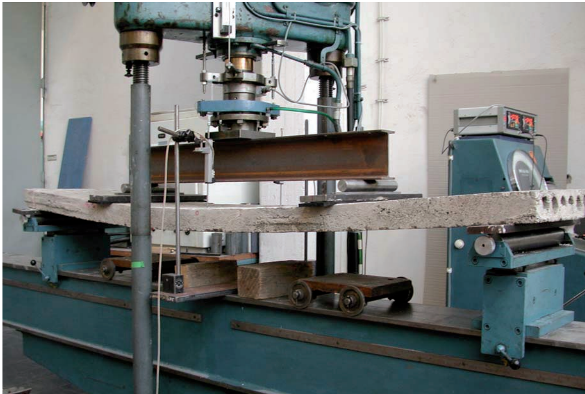
Abb.: 4-Punkt Biegeversuch an einer Bimsbetonhohldiele aus altem Baubestand
