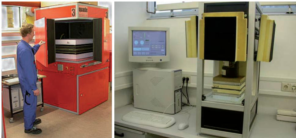
Bild 8: Bestimmung des Wärmedurchlasswiderstandes von Dämmstoffen (Zweiplattengerät)
