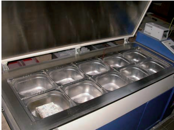
Bild 4: CDF-Truhe zur Prüfung des Frostwiderstands von Baustoffen
