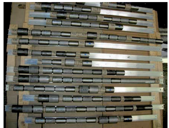
Prüfstand zur Prüfung von Kesselrohren und Druck- und Dampfbedingungen und Prüflinge vor dem Verschweißen und Einbau in den Prüfstand
