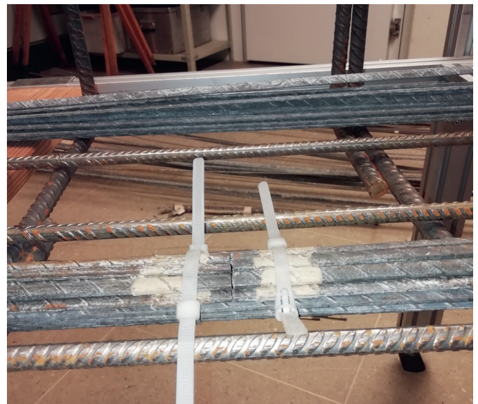
Abbildung 6: Beispiel eines Spannstahlbündels mit 25 % Querschnittsschwächung (6/24), Bruchorientierung Abgewandt und Bruch zwischen den Bügeln
