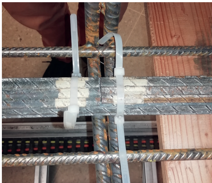
Abbildung 7: Bruchufer direkt über den offenen Bügelenden – 21 % Querschnittsschwächung (5/24) und Bruchorientierung Abgewandt
