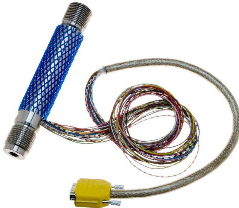
Bild 3: Das Kraftmessglied mit innenliegenden DMS als Kraftmesssensoren
