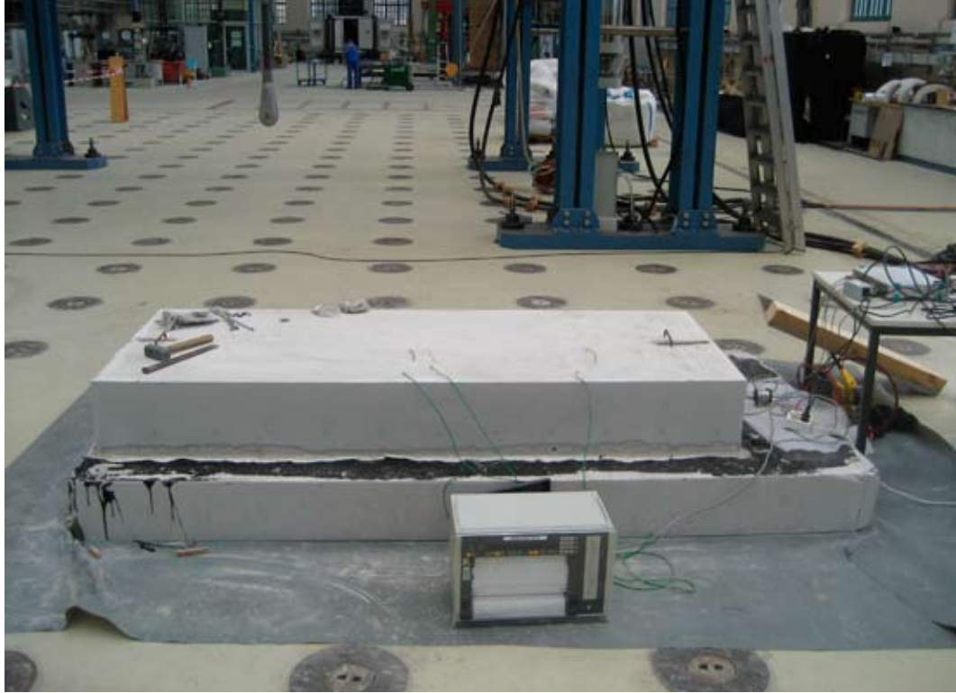
Abb.4 Versuchsaufbau in der TU Berlin zum Nachweis des Gleitwiderstands der Bitumen-Gleitschicht
